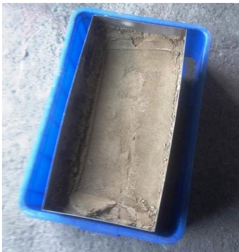
(a)在可拆卸金屬桶中將土壤壓實
