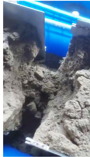
(c)拆開金屬桶土壤已鬆垮崩塌
